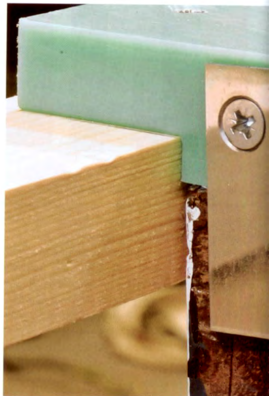
De dikte van de lip bepaalt de bovenste hangnaad (2 mm).
